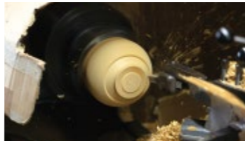
↑木地の状態を見極めつつ旋盤で仕上げ
